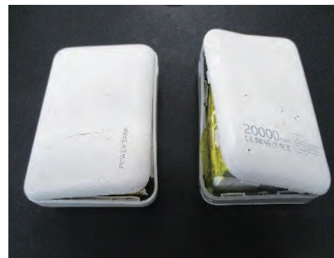
膨張、変形した モバイルバッテリー
